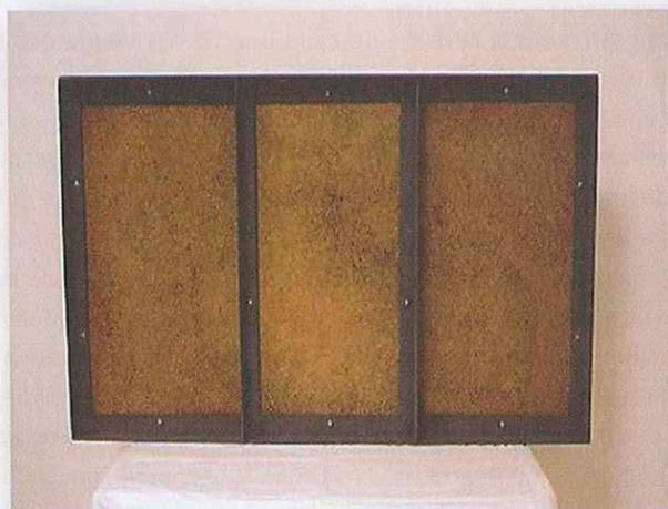
Figura 1. Tablero de acero como bastidor para tarima tipo cimbra, la cara de contacto es el tablero producto de éste trabajo de investigación.
