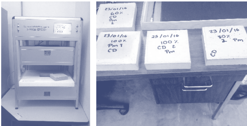
Fig. 2.- Muestras para la medición de conductividad térmica con el equipo Ep-500 e.
