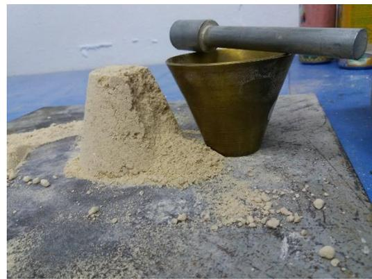
Fig. 3.6 muestra saturada superficialmente seca.
