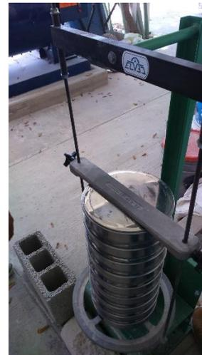
Fig. 3.2 Juego de mallas ASTM y agitador.
