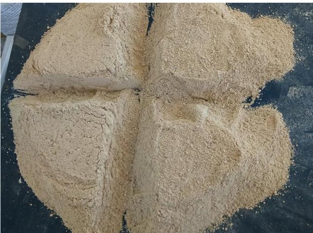
Fig. 3.1 Reduccion de la muestra por cuarteo.
