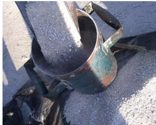
Fig. 3.5 Obtención del peso de la muestra.
