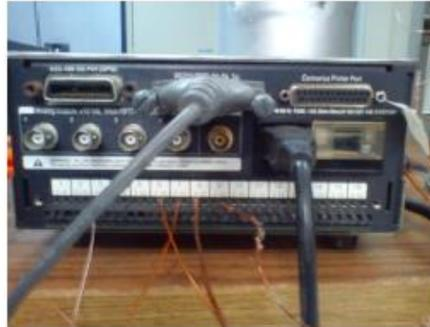
FIGURA 3.16. termopares conectados al monitor SR630
