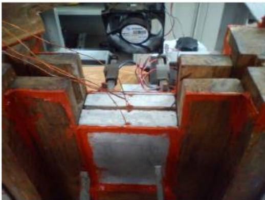
FIGURA 3.14. Probetas colocadas en el conductímetro
